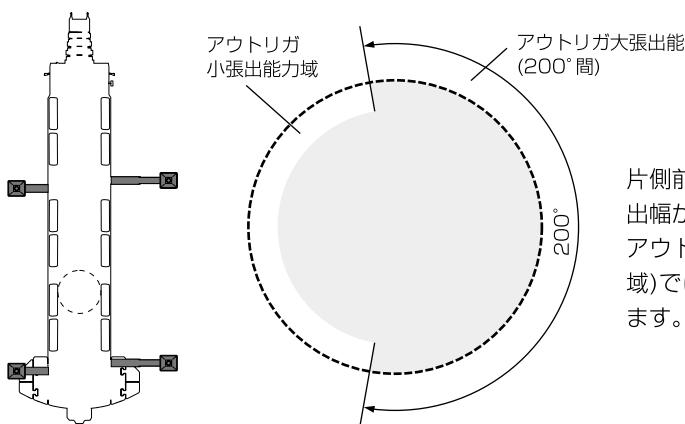
片側前後のアウトリガ張出幅が同じで、左右で張出幅が異なる場合。
