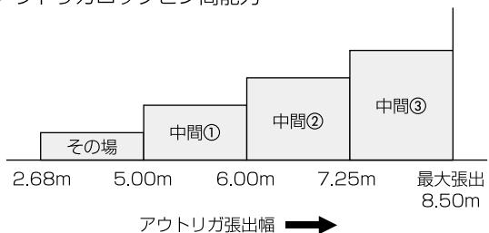
片側前後のアウトリガ張出幅が同じ場合、アウトリガロックピン位置以外でも能力が設定されています。アウトリガロックピン間では、実際の張出幅から1段下の中間張出幅の能力で作業できます。たとえば、実際のアウトリガ張出幅が5.50mの場合、1段下の5.00mの中間張出幅能力が表示されます。
